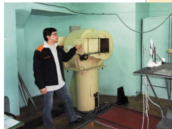
Выполнение работ по градуировке, наладке, поверке дозиметрических и радиометрических приборов с использованием дозиметрической линейки
