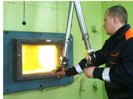
Выполнение работ по монтажу и демонтажу источников ионизирующего излучения в горячей камере
